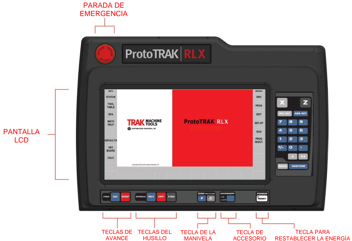
Figura 3.3.1 - La parte frontal del mando del panel colgante del controlador de la ProtoTRAK RLX.
